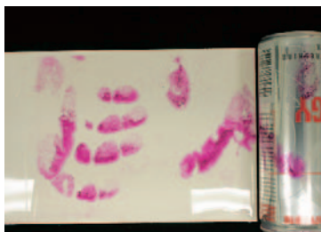
EMPREINTES DIGITALES SUR UNE CANETTE DE BOISSON GAZEUSE TRAITÉES AVEC DU ROUGE DE HONGRIE ET PRÉLEVÉES AVEC UN GELLIFTER BLANC : LES EMPREINTES DIGITALES SONT COPIÉES SUR LE GELLIFTER BLANC
