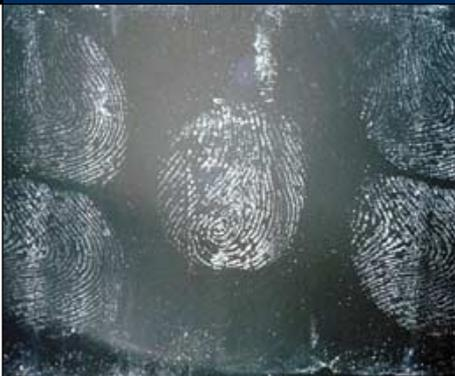
Impressão revelada com cianoacrilato e levantada com Gellifter preto (na figura a bateria foi rolada sobre a superfície do levantador). Em geral é possível repetir este procedimento diversas vezes até a exaustão dos vestígios. A fotografia deve ser invertida de modo a facilitar a comparação da impressão levantada com a impressão encontrada na bateria.
